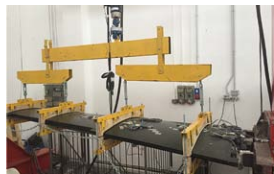
Test di fatica che riproduce le condizioni di volo su una semiala strumentata per il monitoraggio dei campi di deformazione
